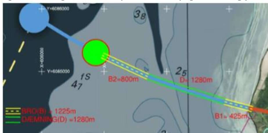
Figur 1.3. Forslag C: to lavbroer (800 m. + 425 m.) og en dæmning (1280 m.)
