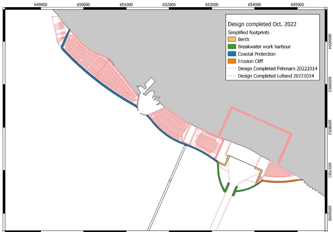
Figur 4.4 Designet for den endelige udformning af landvindinger og arbejdshavn er modtaget fra Fehmern A/S som GIS lag (lyserød). Relevante dele er udtrukket herfra, se "Simplified footprints". Koordinater er i UTM-32.
