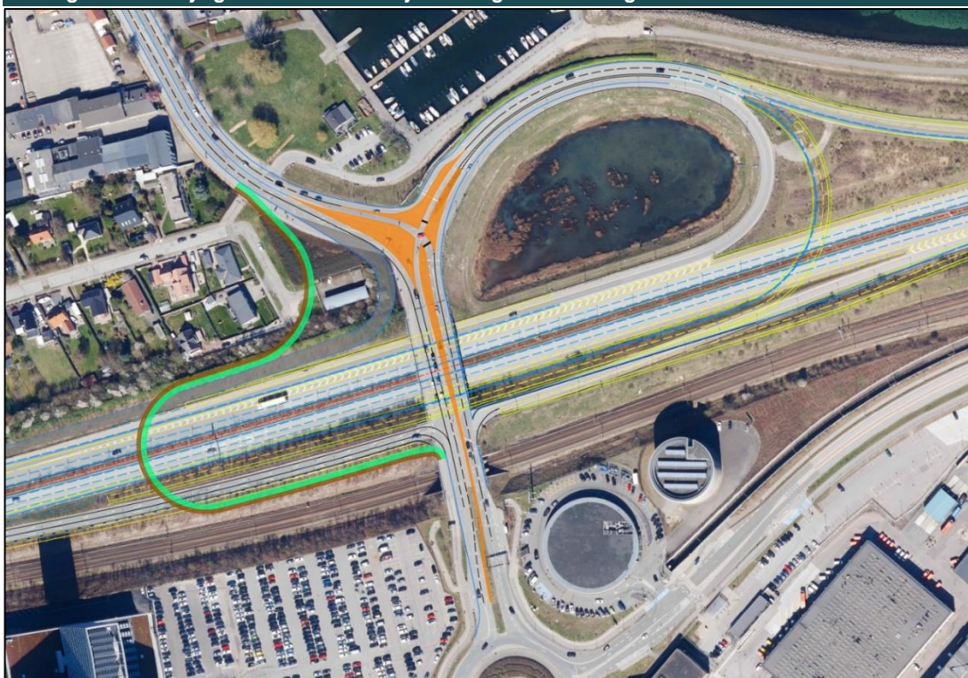
FIGUR 14.18 Løsning A3s. Stibro over Øresundsmotorvejen samt frakørselsrampe mellem Amager Strandvej og Øresundsmotorvejen i vestgående retning
