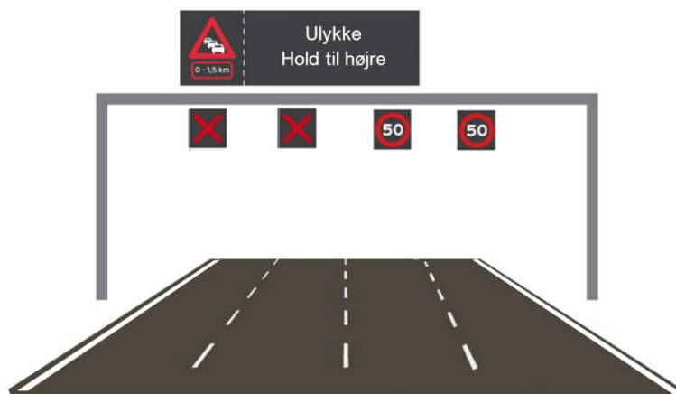
Figur 5.4 Eksempel på portal med både hastigheds- og vognbaneregulering samt informationstavle. Tværprofil vist for en 4 sporet motorvejsstrækning uden nødspor
