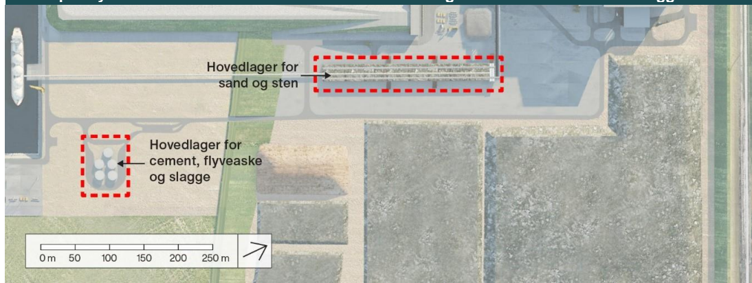
FIGUR 3.22 Hovedlagre for cement, flyveaske/slagge, sand og stenfraktioner samt transportsystemer for disse betonmaterialer fra havnen og videre til betonblandeanlæggene
