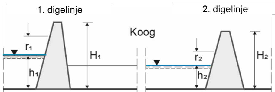
Figur 7.25. Skitse over beregningsparametre ved dobbelt digelinje.
