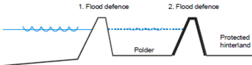
Figur 7.24. Principskitse for dobbelt beskyttelseslinje bestående af to diger.
