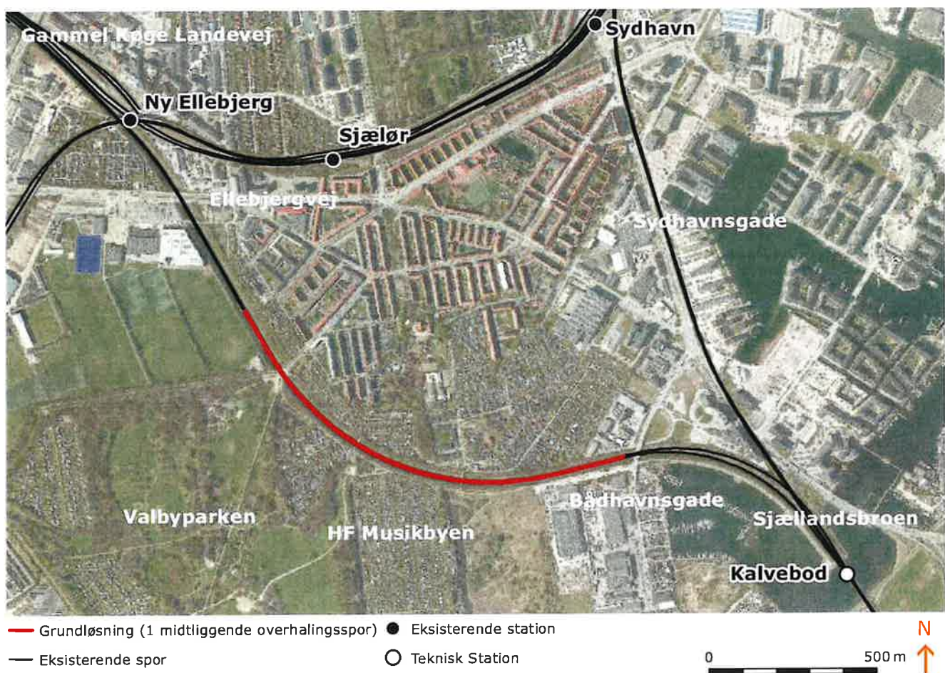
Figur 7. Oversigtskort over grundløsningen med ét midtliggende overhalingsspor mellem Kalvebod og Ny Ellebjerg
