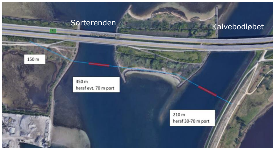
Figur 1-1: Linjeføring af stormflodssikring med hhv. to porte (Løsningstype 1) og én port i Kalvebodløbet og en dæmningskonstruktion i Sorterenden (Løsningstype 2). Der er tale om et eksempel, og således er det af mindre betydning, hvorvidt der etableres én eller flere porte i Kalvebodløbet og Sorterenden samt bredden af disse (COWI, 2020).
