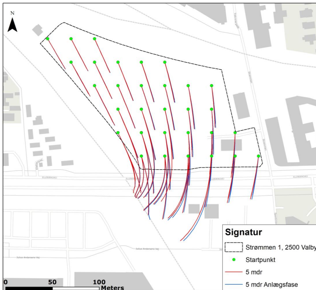
Figur 3.5. Forskelle i grundvandsstrømning for hhv. Nuværende drænforhold (rød) og grundvandssænkning i anlægsfasen (blå) efter en anlægsperiode på 5 mdr. Partiklernes startpunkter er vist med grønt.
